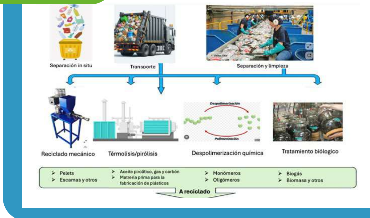
Figura 2. Diagrama del reciclado, incluyendo pretratamiento y procesos. Modificado Jiang & Bateer, 2025
